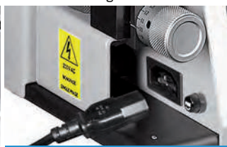
Cavo di collegamento elettrico e fusibile
