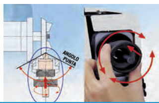
Regolazione della lunghezza e posizionamento della punta
