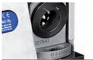
Affilatura dell'angolo e realizzazione della spoglia
