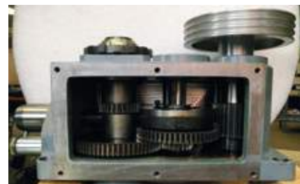
Scatola ingranaggi in bagno d'olio.
